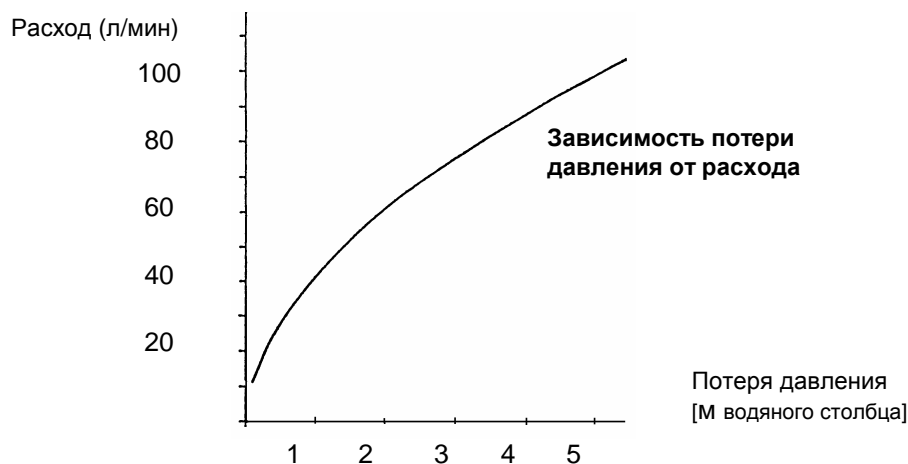
Рис. №. 23 Характеристика трехходового клапана Honeywell V 4044F
