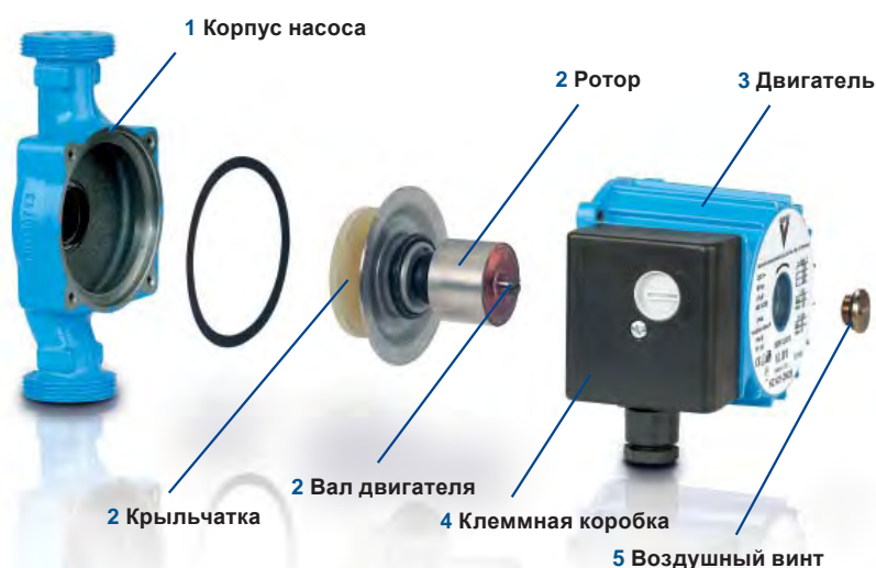
Разрез НЗ 401 – DN 25
